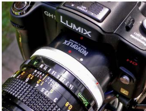
Die Panasonic GH1 mit 14-140 mm Zoom (oben) und mit Novoflex-Adapter für Canon-FD-Objektive (unten)
